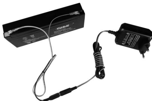
Рис. 29. Внешний заряд аккумулятора: подсоединение к переходному разъему на кабеле зарядного устройства соединительного кабеля с клеммами для подключения к аккумулятору и подсоединение клемм кабеля зарядного устройства к выводам аккумулятора
