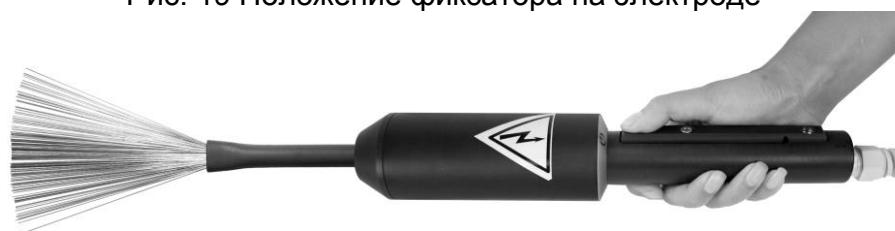
Рис. 20 Положение электрода, закрепленного в высоковольтном трансформаторе-держателе
