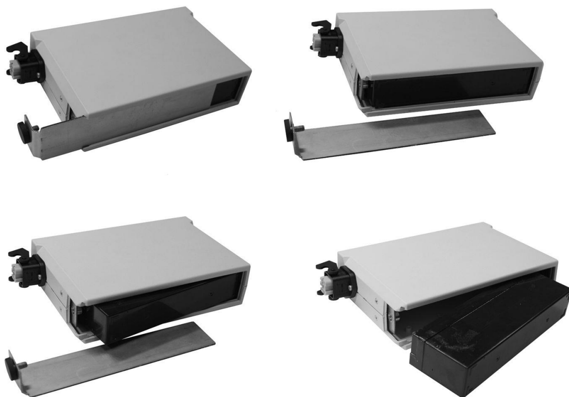
Рис. 30. Последовательность действий при замене аккумулятора
