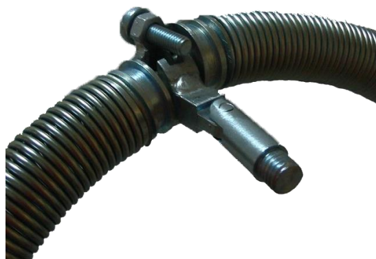
Рис. 22. Подготовленный к проведению контроля пружинный электрод
