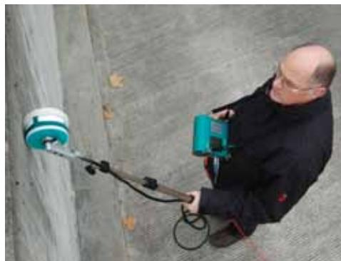
1-роликовый электрод для быстрого сканирования больших площадей
