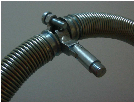
Рис. 19. Подготовленный к проведению контроля пружинный электрод
