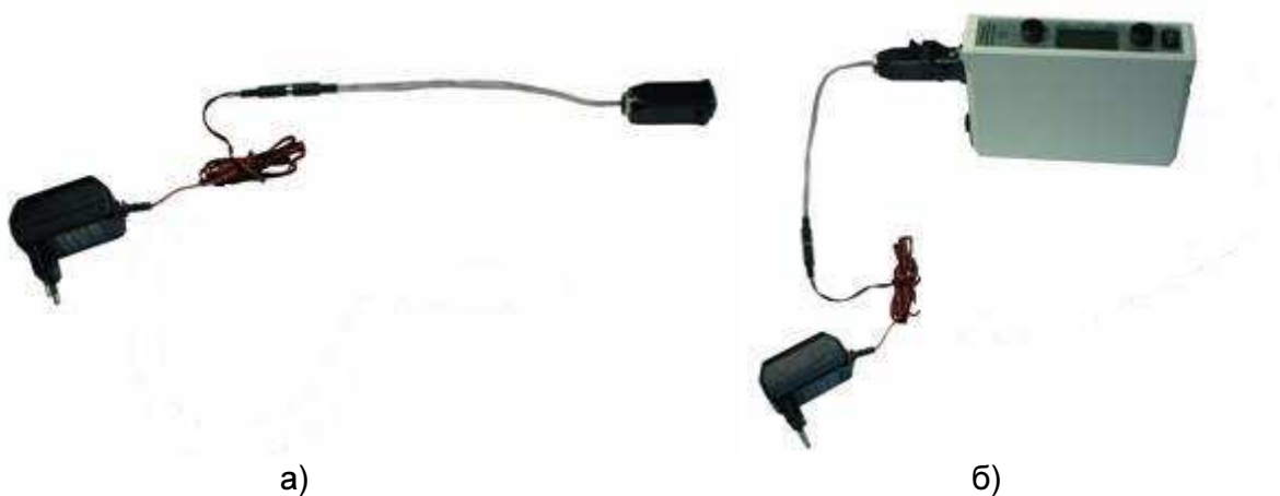
Рис. 22. Заряд аккумулятора в блоке контроля: а) подсоединение соединительного кабеля к переходному разъему; б) подсоединение выходного кабеля зарядного устройства к разъему «X1» блока контроля
