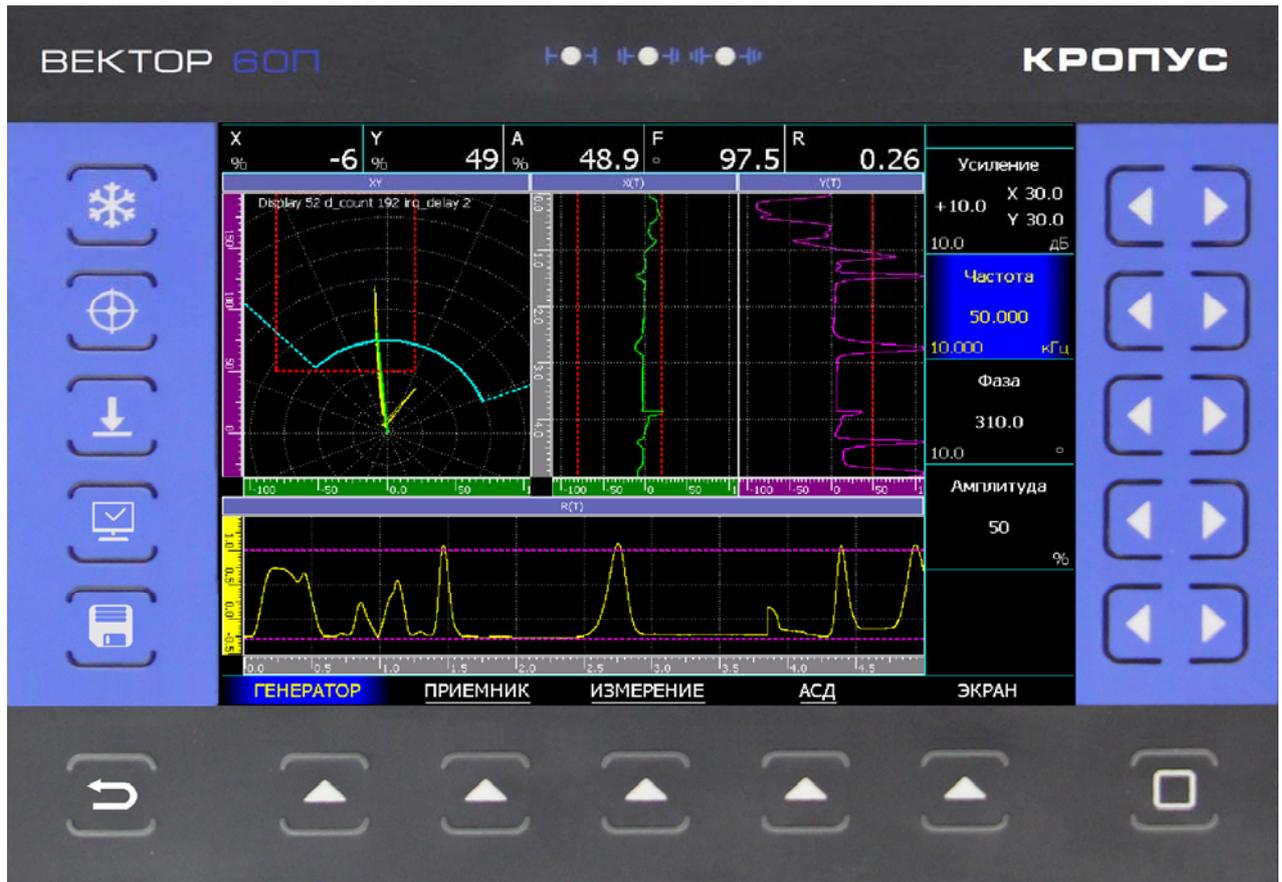
Рисунок 4. Клавиатура дефектоскопа
