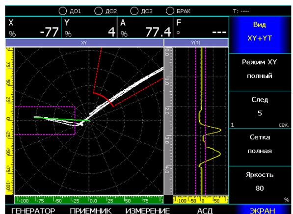
«XY+YT» - комплексная плоскость и график сигнала Y(t)
