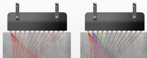
В приборе используется метод синтезированной фокусируемой апертуры с комбинированным зондированием (САФТ-К), при котором происходит фокусировка ультразвука в каждую точку полупространства.
