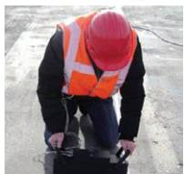
**Контроль** проводится по схеме пошагового сканирования объекта контроля с объединением данных и реконструкцией объема под всей отсканированной площадью объекта контроля.
